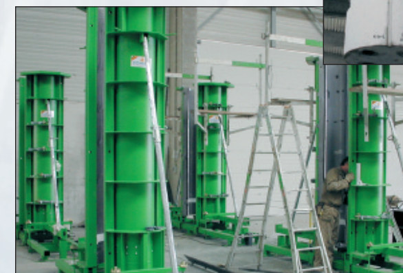
Marmorith nv - Mal voor prefabkolom - Gerechtsgebouw Antwerpen.
